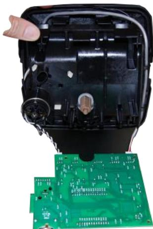
MONTAR NUEVAMENTE EL SOPORTE CIRCUITO IMPRESO, PRESTANDO ATENCIÓN A POSICIONARLO Y BLOQUEARLO CORRECTAMENTE
