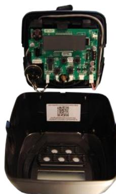
DESMONTAR LA TAPA DELANTERA
