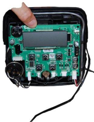
MONTAR NUEVAMENTE EL CIRCUITO IMPRESO, PRESTANDO ATENCIÓN A POSICIONARLO Y BLOQUEARLO CORRECTAMENTE
