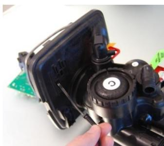
INTRODUCIR EL CABLE DE CONEXIÓN A LA CELDA DE TITANIO
