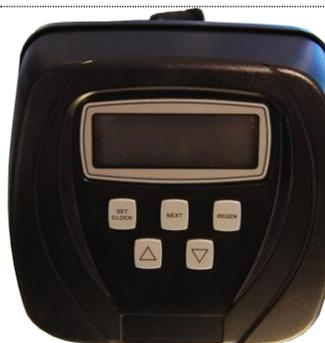
MONTAR LA TAPA DE LA VÁLVULA Y COMPROBAR QUE LAS TECLAS SE ENCUENTREN EN LA POSICIÓN CORRECTA
