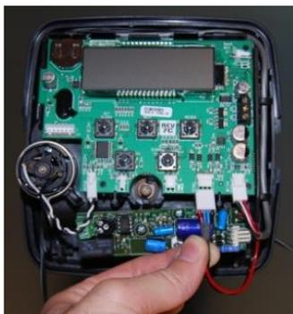
CONECTAR EL CABLE DEL GENERADOR DE CLORO COMO ILUSTRA LA FIGURA
