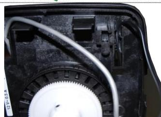
HACER PASAR EL CABLE A LA DERECHA DE LA VÁLVULA COMO SE MUESTRA EN LA FIGURA; INTRODUCIR LOS CABLES EN LOS PASANTES CORRESPONDIENTES
